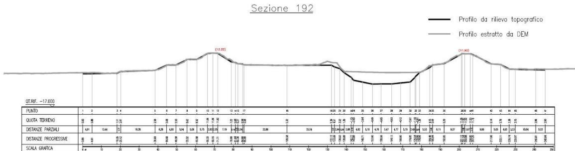
Figura 11 - Confronto tra il profilo del terreno lungo la sezione trasversale 192 fornito dal rilievo tradizionale e quello ottenuto dal DEM con strumenti GIS.
