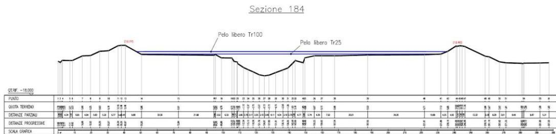
**Figura 24 - Massimi livelli del profilo del pelo libero delle piene 25-ennale e 100-ennale in alcune sezioni del tratto di interesse.**
