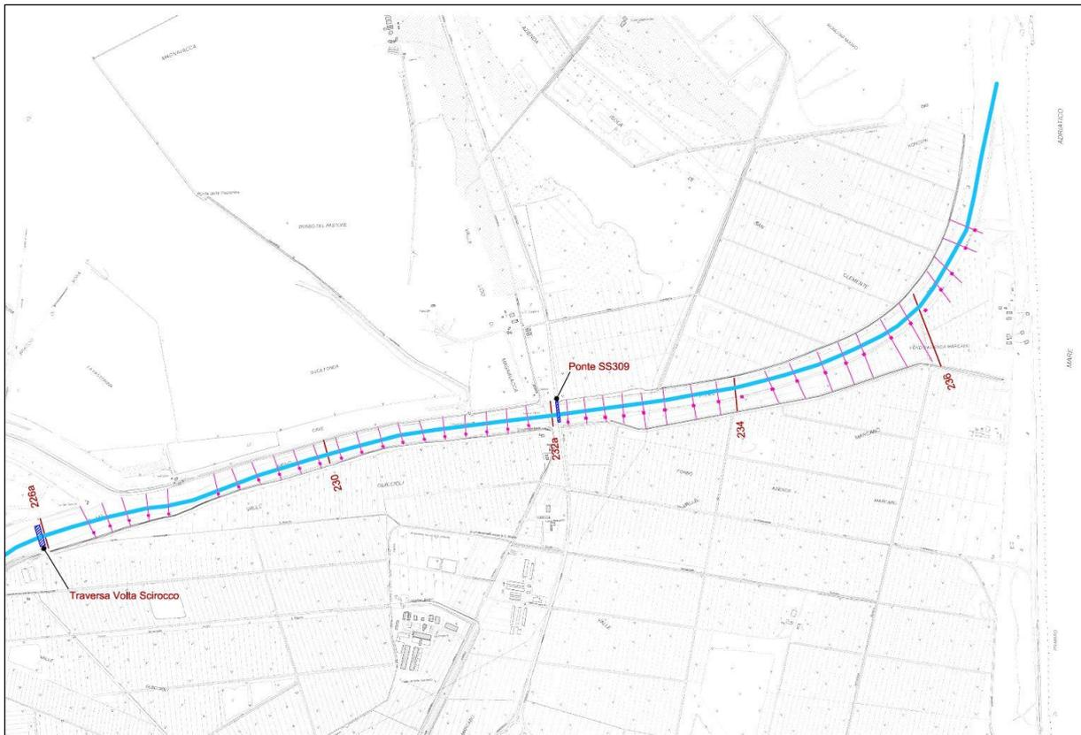
Figura 32 – Ubicazione dei capanni, delle sezioni trasversali del rilievo topografico e di quelle aggiuntive, utilizzate per la modellazione specifica dell'effetto dei capanni, nel tratto terminale del fiume Reno.
